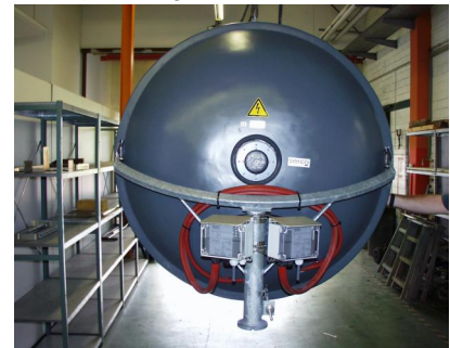
1,2 m Antenne mit De-Icing-System
