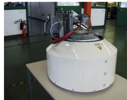
0,6 m Antenne mit De-Icing-System
